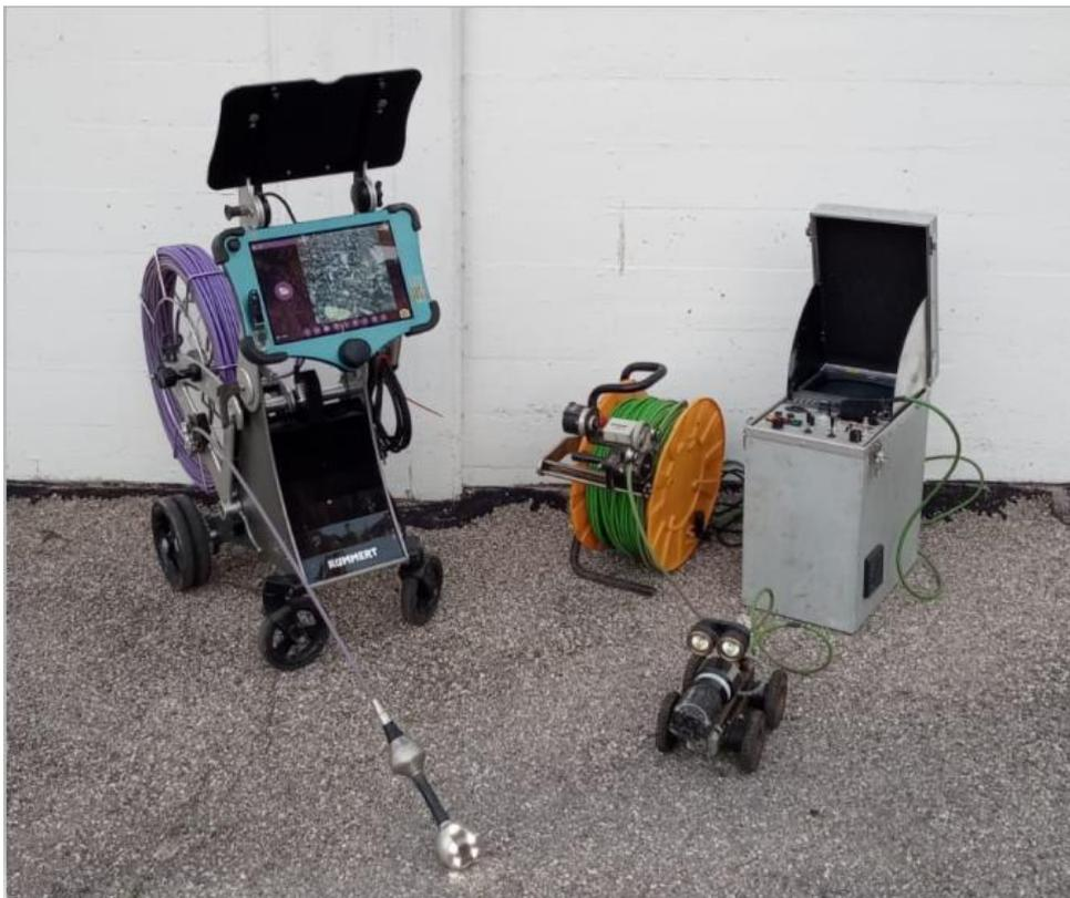
Abbildung 5 Kanalkameras der Stadtentwässerung Freising <sup>5</sup>
