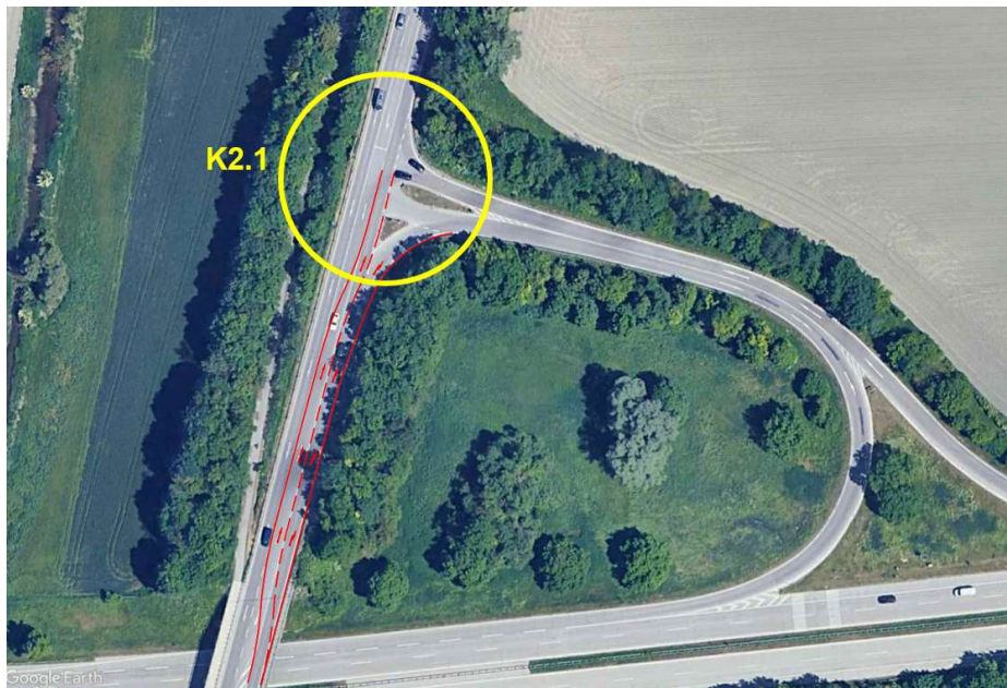
Abbildung 29: Skizzenhafte Darstellung der verlängerten RA-Spur am Knoten K2.1 (Quelle Hintergrundkarte: Google Earth)
