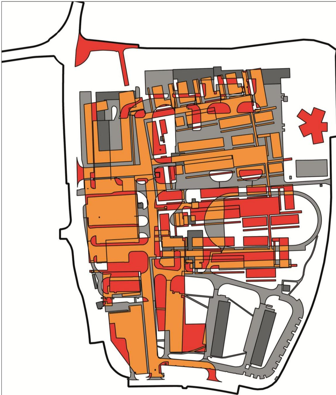
Abbildung 2: visuelle Überlagerung von Bestand (grau) und Planung (orange) und der sich hieraus ergebende zusätzliche Versiegelungsbedarf (rot)
