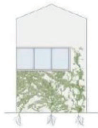
Flächenförmiger Direktbewuchs der Fassade mit Selbstklimmer
